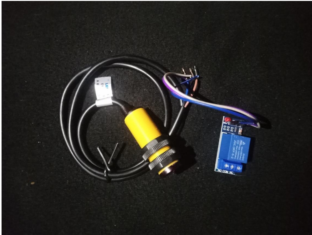
Gambar 27. Rangkaian IR dan relay
